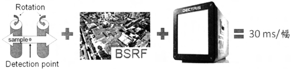
图 5.1 超快检测实验设备示意图。从左到右依次为:伸展流变仪、北京光源示意图 (BSRF) 和 Pilatus 探测器。
