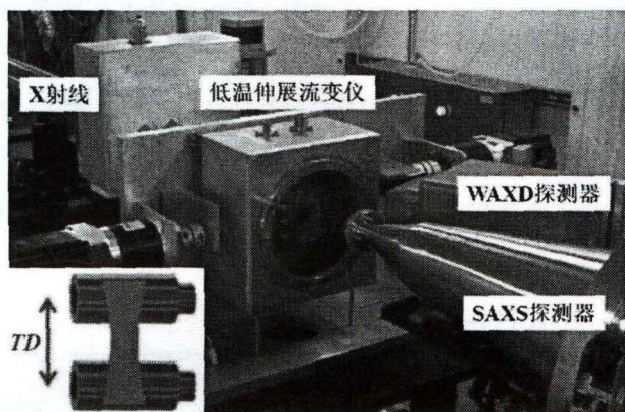
图 3.1 自研的低温伸展流变仪与上海光源 16B 小角站联用。
