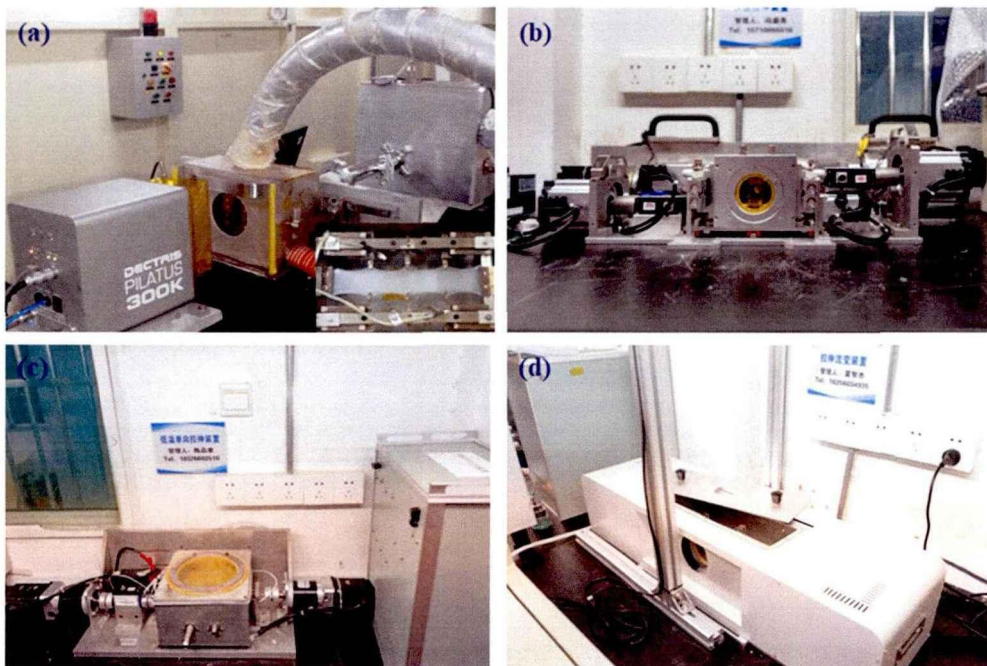
图 2.6 与同步辐射 X 射线散射技术联用的 (a) 恒幅宽拉伸装置、(b) 高速拉伸装置、(c) 低温拉伸装置和 (d) 溶液拉伸装置。
