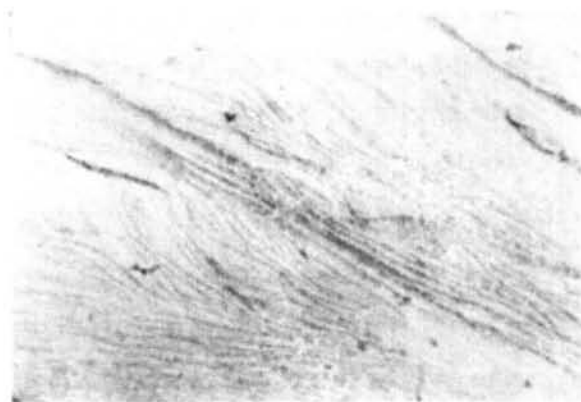
图 1.20 聚乙烯球晶内部晶片结构的电子显微镜照片。 46
