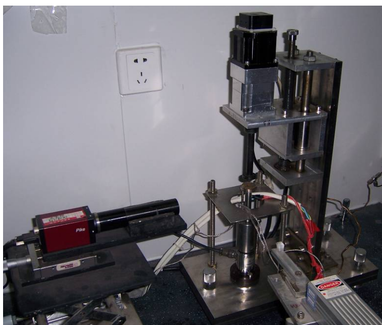
图 2.10 配合 PTV 技术的锥板-平板流变仪的实物图。
