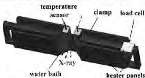
图 4.1. 自制带水槽的薄膜拉伸装置示意图
