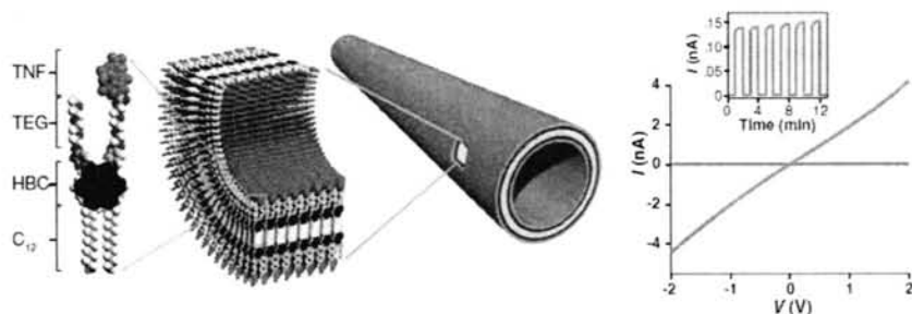
图1.8 超分子纳米管p-n结及其光伏性能曲线 [36,55] 。
